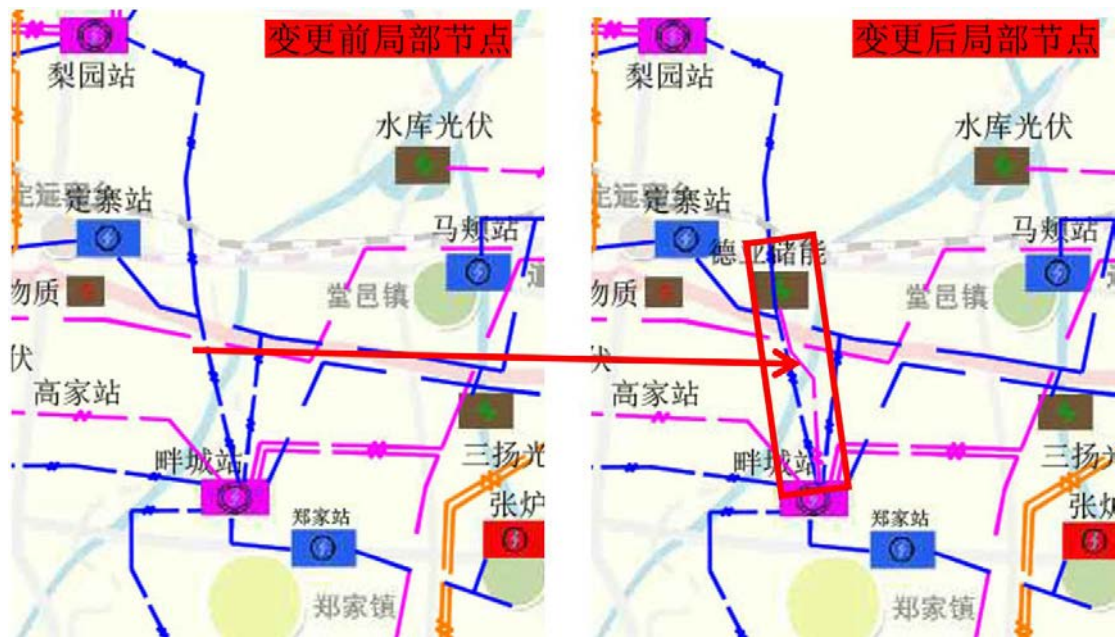
图 4-4 市域 110kV 及以上电网地理接线优化局部对比图
